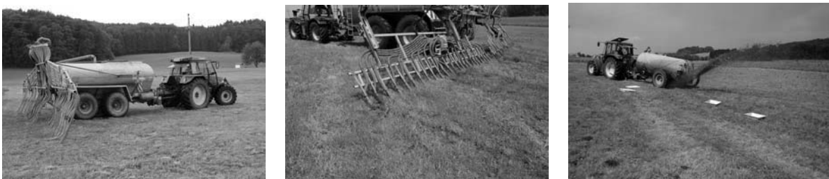
Abbildung 4: untersuchte Gülleapplikationstechniken – Schleppschauch, Schleppschuh und Prallteller
